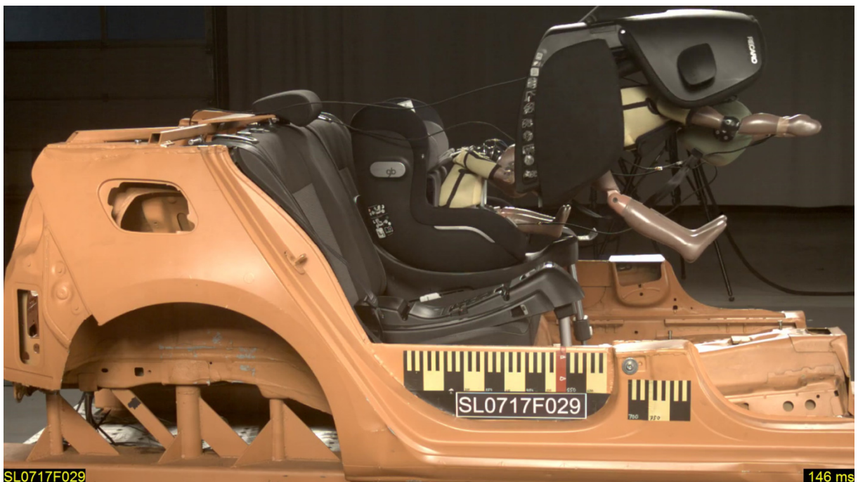
Figura 1: Recaro Optia & Smart Click Base en el test de impacto frontal
