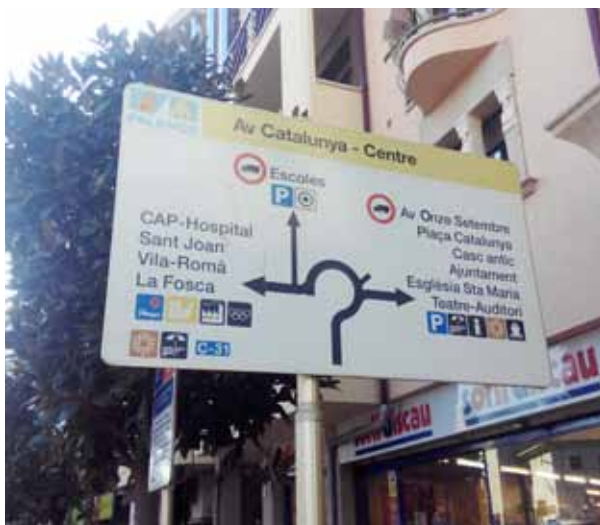
Presenyalització d'una rotonda amb un excessiu nombre d'elements i de pictogrames (Av. de Catalunya, Palamós)
