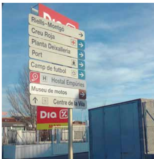
Excés de mencions, manca d'uniformitat i col·locació incorrecta (GI-630)
