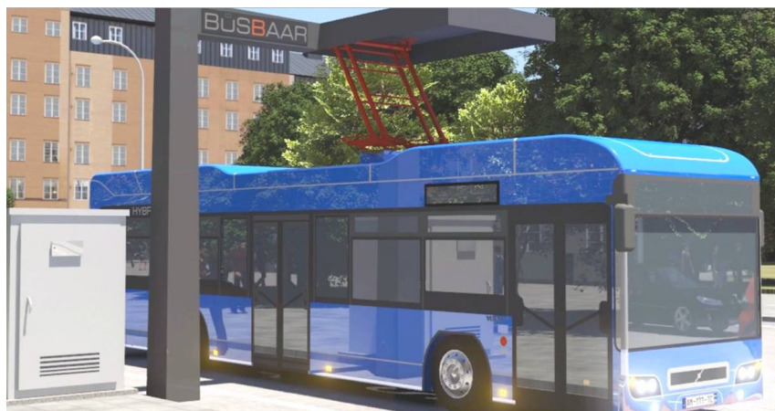
Imatge 30: BusBaar, parada de bus amb càrrega ràpida
